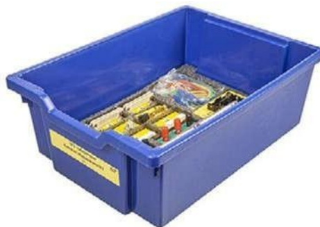
Рис. 6. Комплект сопутствующих элементов для экспериментов по электродинамике. В со-
